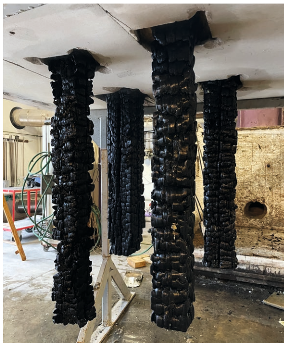
DBI's bidrag til projektet har været brandtests af træ.
